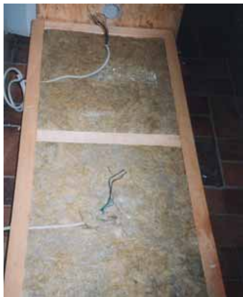
Abb. 3b: Am Versuchsende zurück gebautes Modell mit Elektroinstallation.
