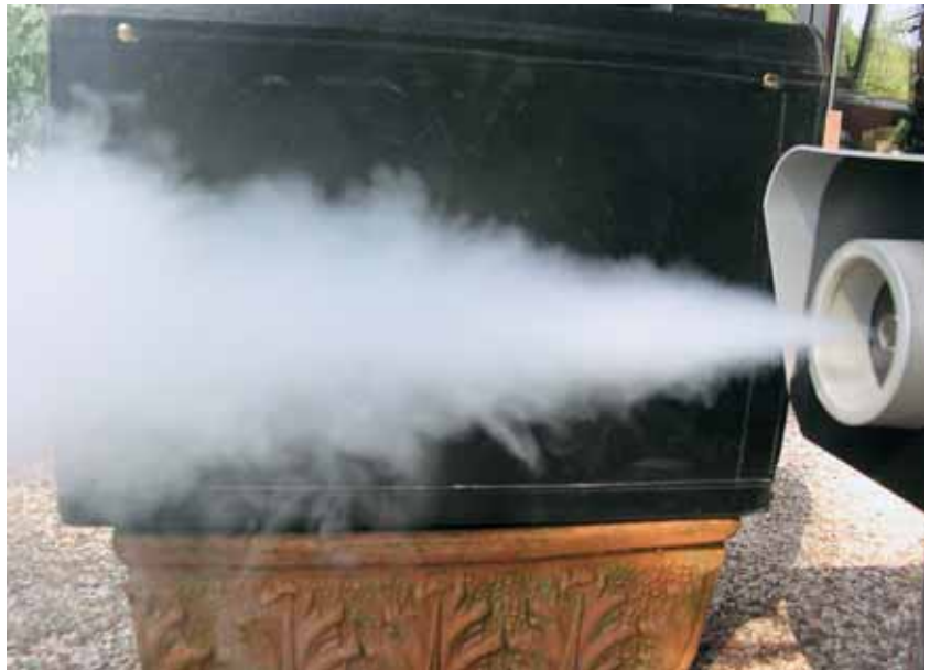
Abb.1. Dampf expandiert wie auch der Nebelaustritt aus der Düse eines Nebelgenerators mit wenigen Millimetern zeigt.
