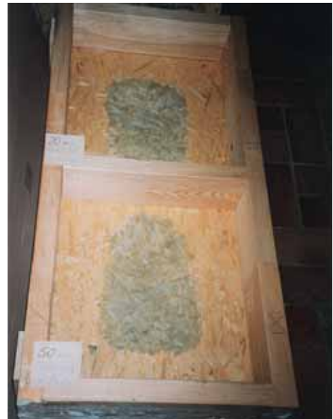
Abb. 2b: Nach Öffnen zum Versuchsende bleibt durch geringe Eisbildung teilweise die Mineralwolle an der äußeren OSB haften.
