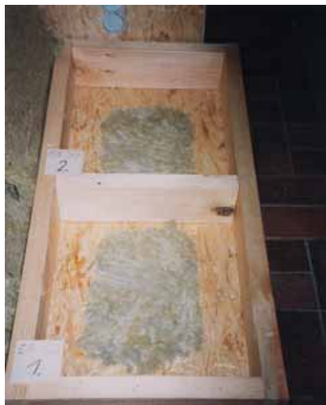
Abb. 3c: Nach Entfernen der Mineralwolle – auch hier haftet Mineralwolle an der äußeren OSB an
